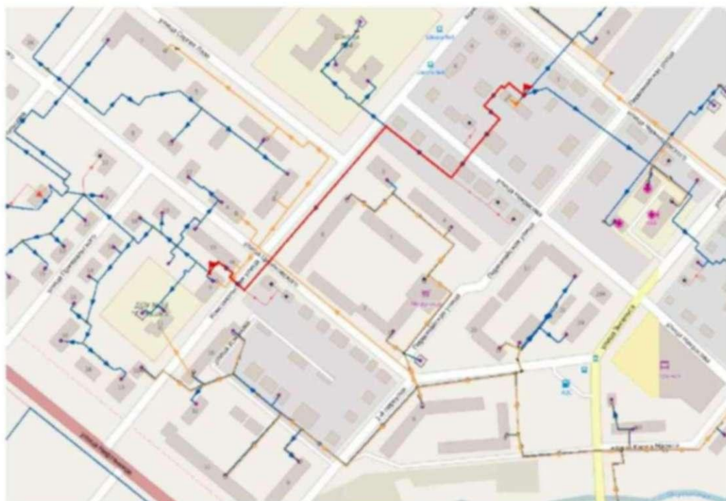
Рис. 5.1 Подключение нагрузок ЦТП 40 кв. к котельной 31 кв.
