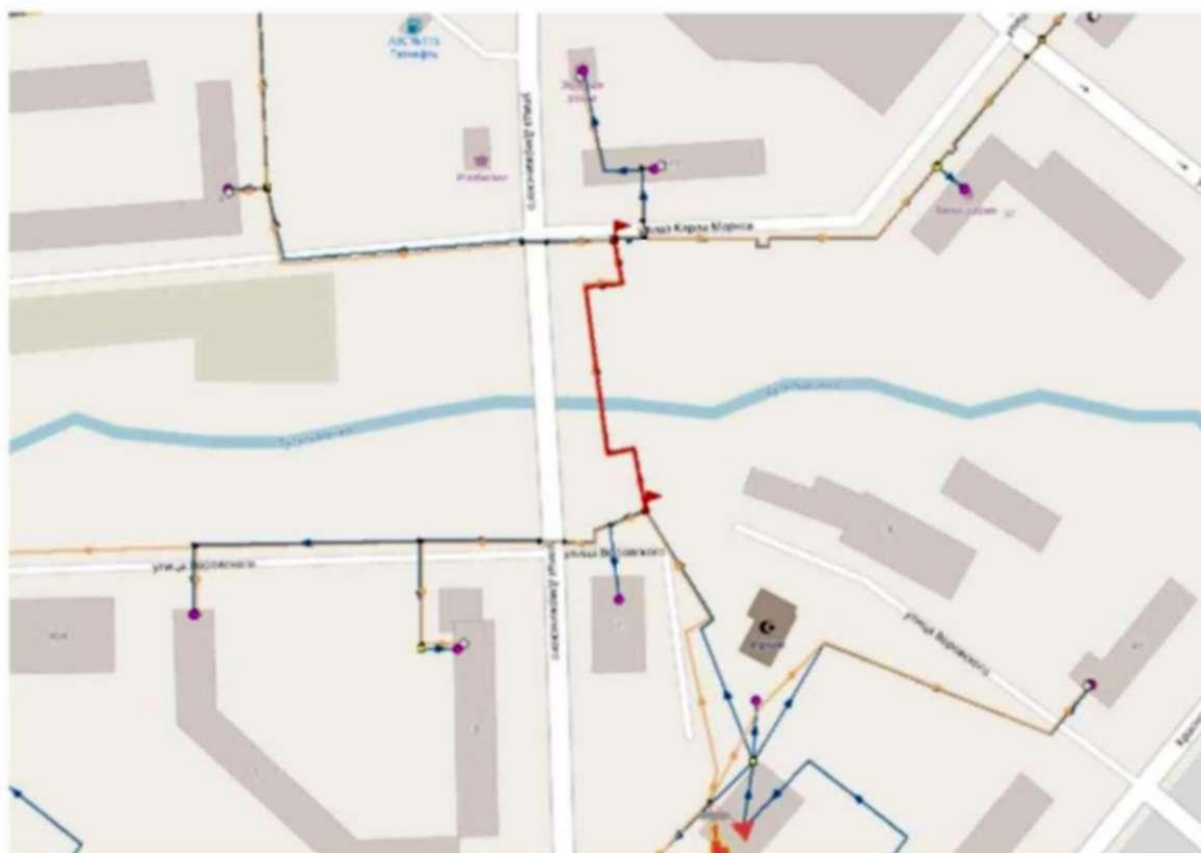
Рис. 5.5 Реконструкция трубопроводов по ул. Дзержинского (через овраг)
